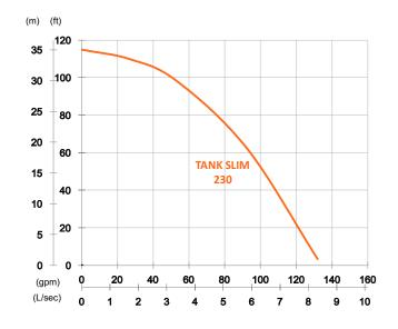
Shaft Speed : 3450 rpm
